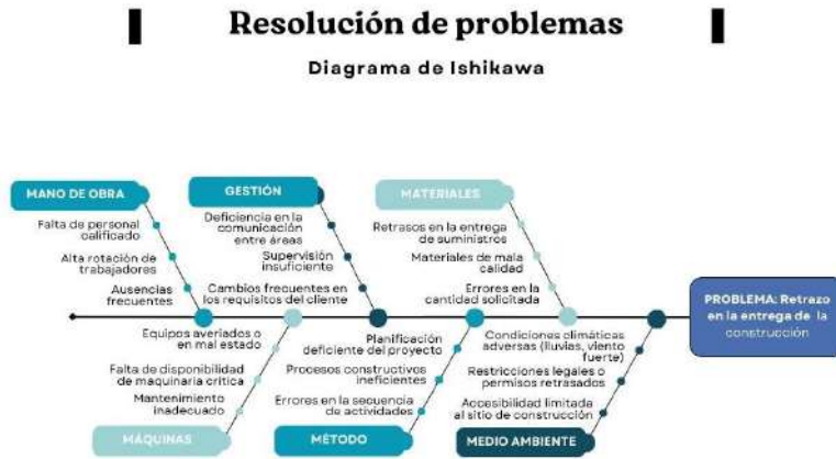
Figura 6.5 Diagrama de Ishikawa -Retraso en la construcción de una vivienda
